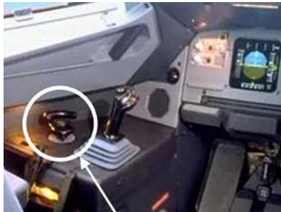
Bild 1.3 Ratt för noshjulsstyrning i cockpit Airbus 320
