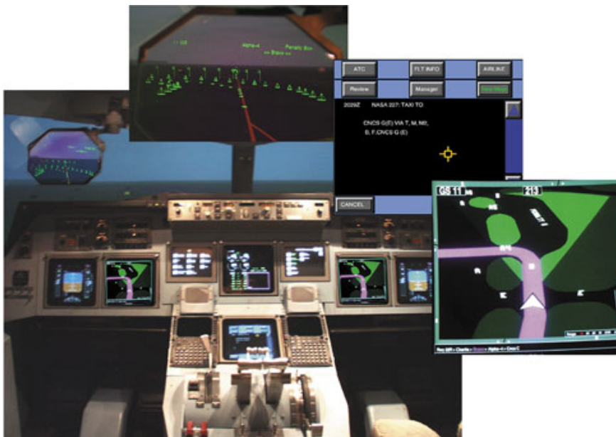
Bild 2.1 Surface Guidance System (SGS) med HUD, AMM och datalänkskärm
