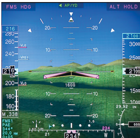
Bild 2.3 Synthetic Vision System (SVS) presenterat på pilotens Primary Flight Display (PFD).
