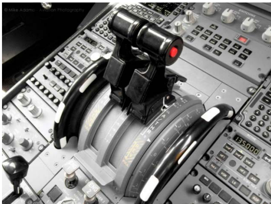
Bild 1.2 Gasreglage i cockpit Airbus A320
