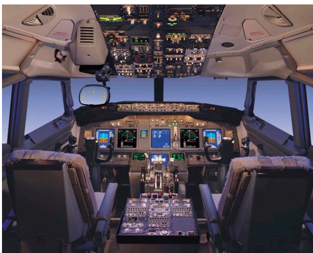
Bild 1.1 Head-Up Display (i bildens övre vänstra hörn), i cockpit Boeing 737-900
